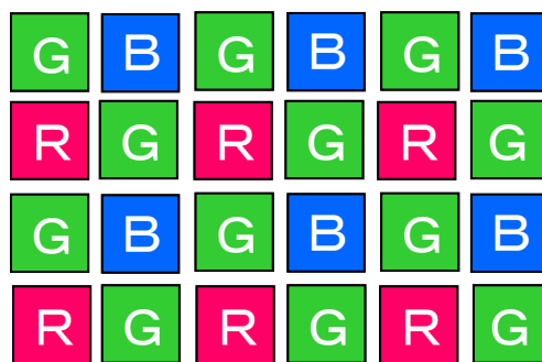
図 2.4 単板式カラーCCD ベイヤ型素子配列の例
