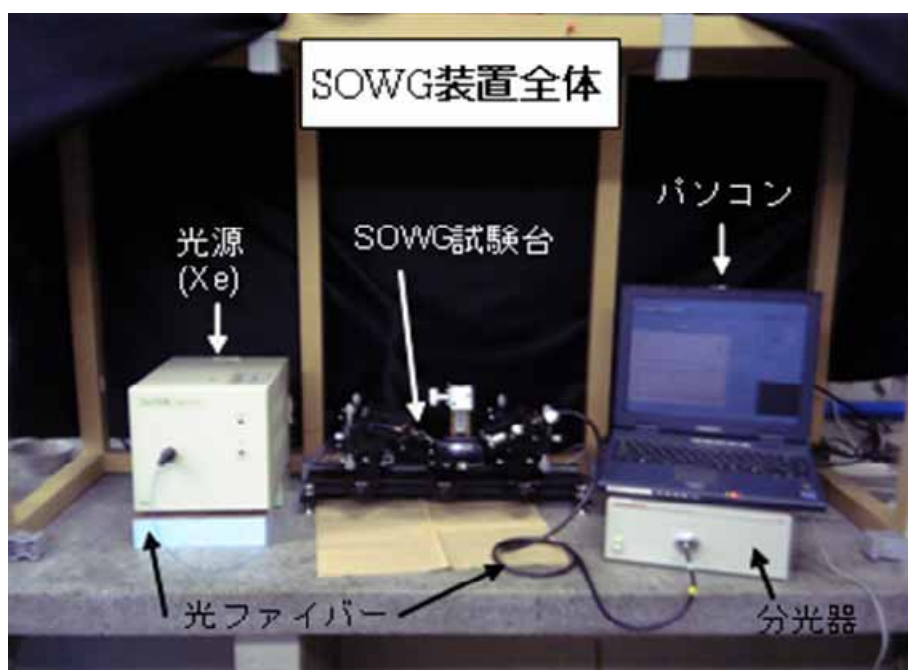
図 2 - 5 酵素活性検出装置の全体の写真
