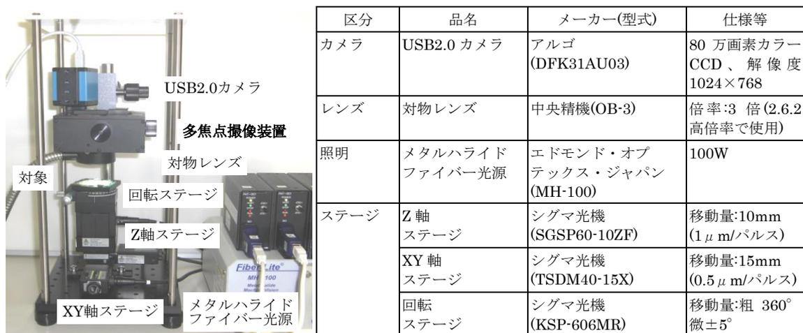
図 2.28 多焦点撮像装置(MFU3)を用いた構成例と構成部品
