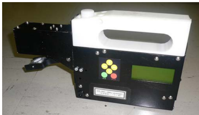
図4.1-7 試作開発した水分ストレス計の概観
